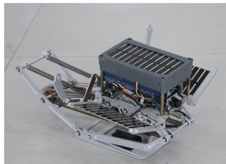
图 10 跳跃机器人试验样机
