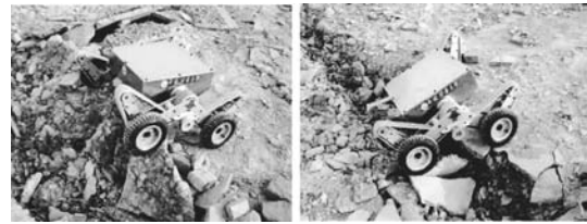
图 19 机器人克服非结构的不平整地形的视频截图
