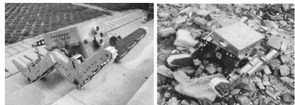
图 20 采用 d_7 悬架机构的机器人样机
