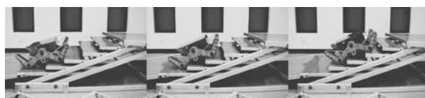
图 11 机器人攀爬连续阶梯过程的视频截图
