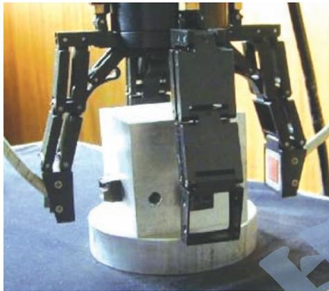
图5 多指多关节机械手照片
