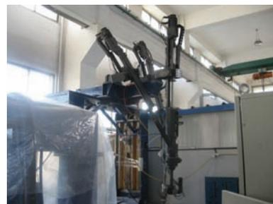
图 1 5 自由度激光焊接机器人结构
