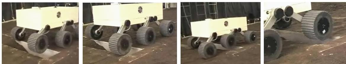
(b) 过直壁沟壑实验 (沟宽度等于 1.2 倍车轮直径)
