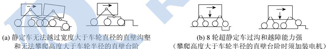
图 1 6 轮静定车和 8 轮超静定车的越障过沟能力对比
