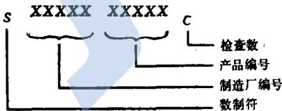
制造厂编号和产品编号占据符号的左、右两半。在条形码符号下面印刷了这些编号。为保证代码不重复，产品编号登记在中央产品号数据库中。批发商和零售商把条形码符号打印在标签上，标签固定在物品上。另外，常把条形码印刷在物品的包装上。
