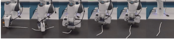
图 7 基于抓取—放置操作的平面 DLO 形状控制任务示例 [64]
