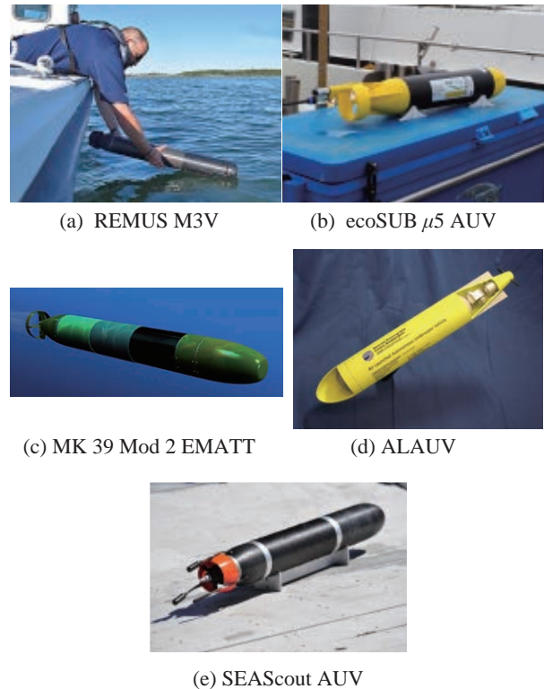
图 2 完全符合 A 型尺寸标准的典型微小型 AUV Fig.2 Typical micro AUVs that fully complies with A-size standard
