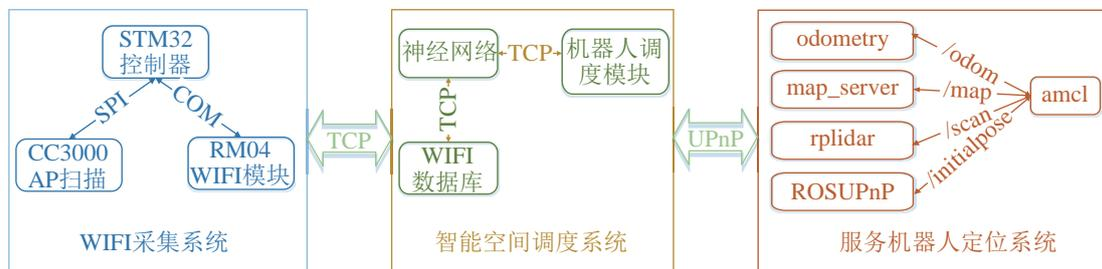
图 1 服务机器人全局定位系统框架
