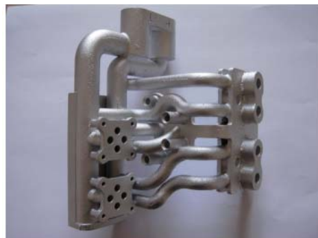
图 13 增材制造液压歧管
